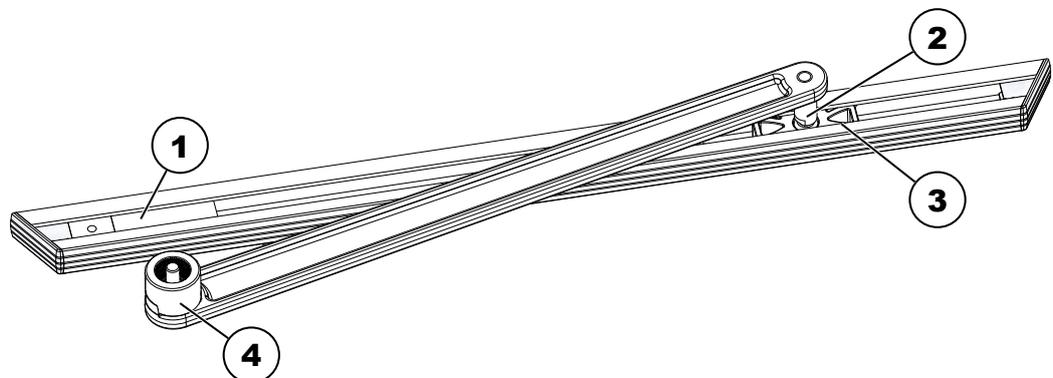
1 Anschlagteller mit Dämpfanschlag
