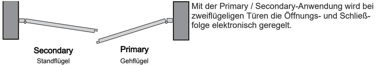
Für zweiflügelige Brandschutztüren wird zusätzlich die mechanische Schließfolgeregung SFR 127 für den Standflügel und den Gehflügel eingebaut.
