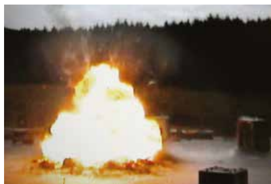
Bei diesem Test werden die Türen dem Überdruck einer Explosion ausgesetzt
