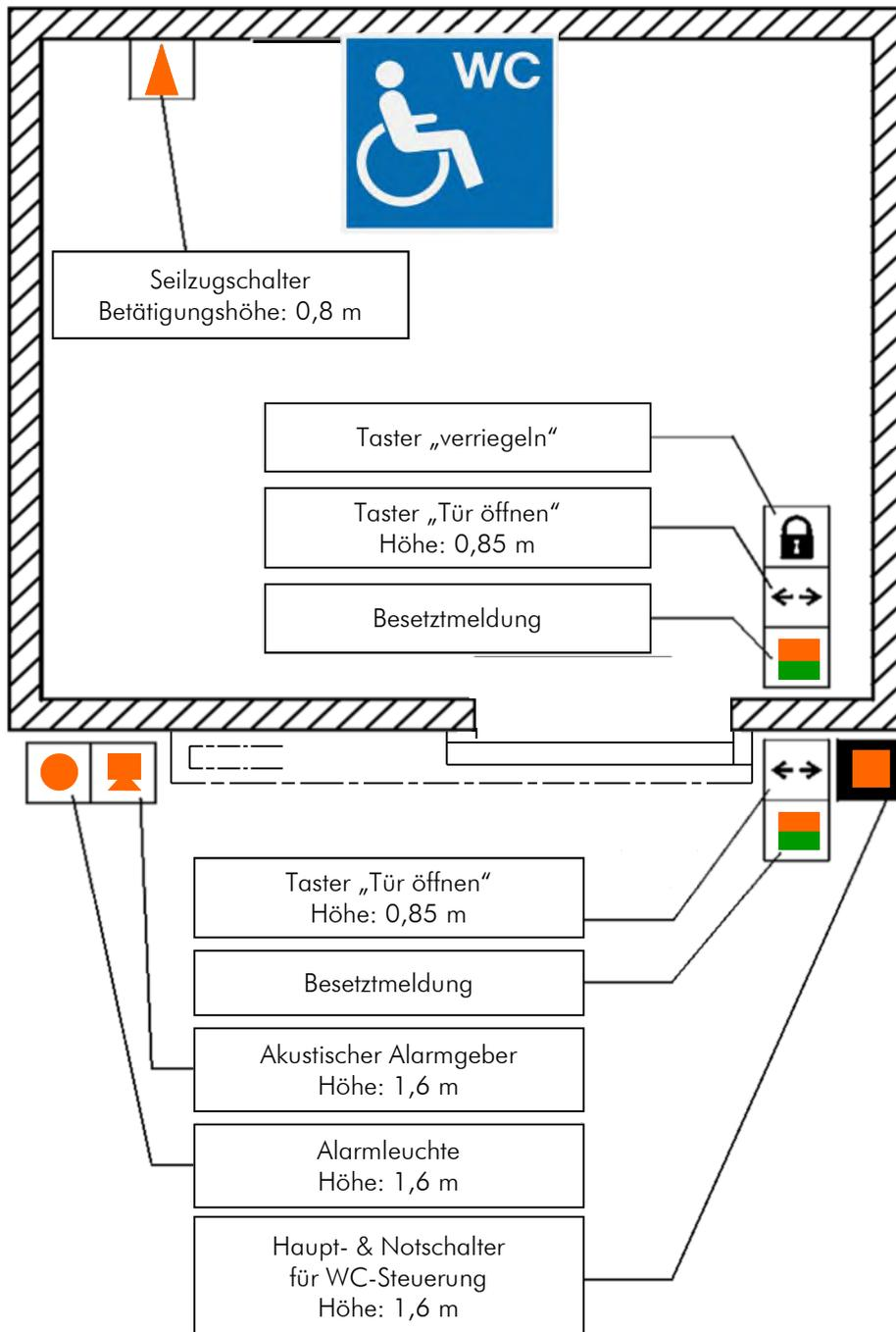
Alle Sicherheitsfunktionen, insbesondere nach ÖNORM EN 16005, werden vom Türantrieb STA 20 und der erforderlichen Sicherheitssensorik ausgeführt. Der Türantrieb wird ohne Verriegelung ausgeliefert. Die Zuhaltung erfolgt über die Motorbremse.
