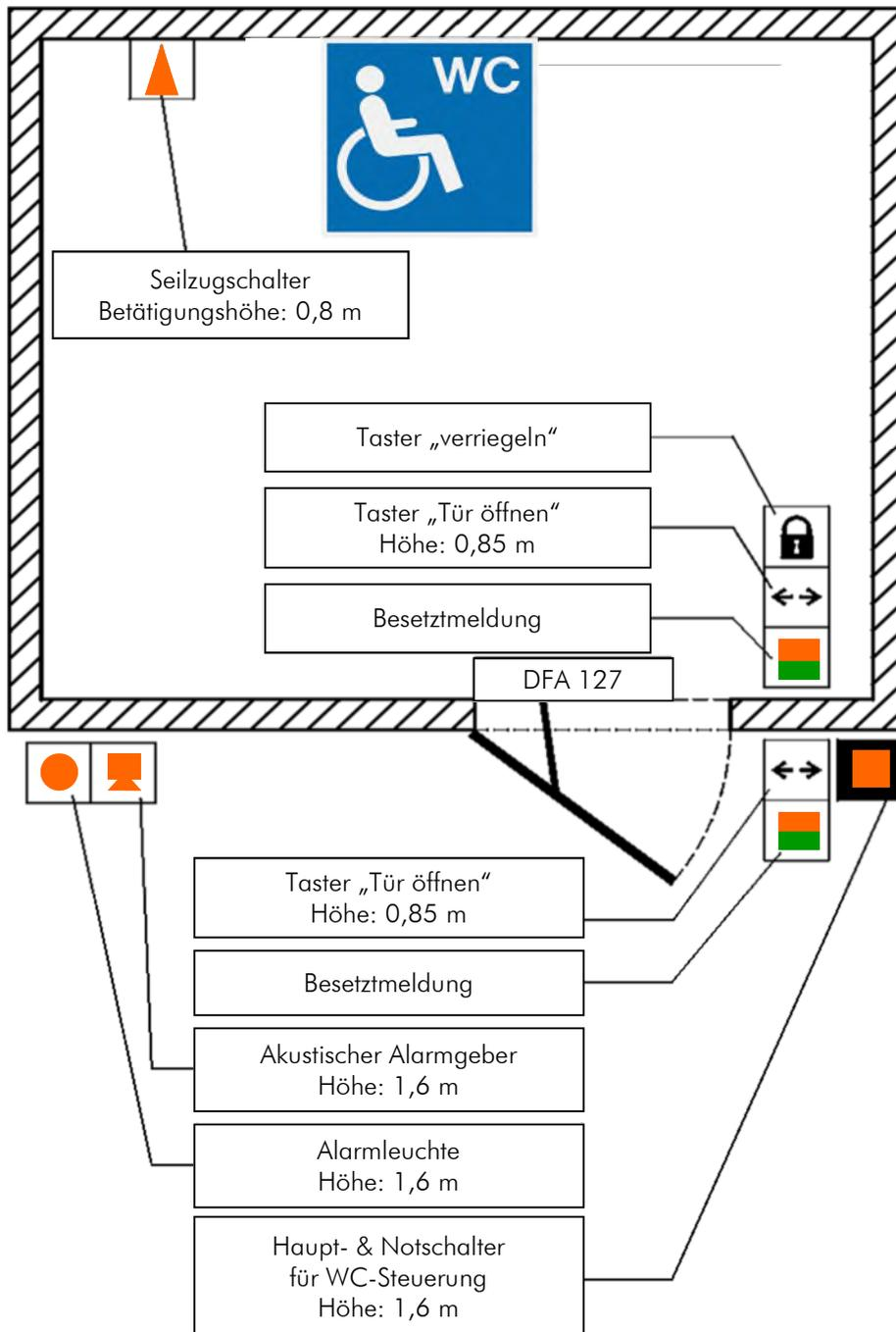
Alle Sicherheitsfunktionen, insbesondere nach ÖNORM EN 16005, werden vom Türantrieb DFA 127 und der erforderlichen Sicherheitssensorik ausgeführt. Der Türantrieb wird ohne Verriegelung ausgeliefert. Die Zuhaltung erfolgt über den bauseitigen E-Öffner (Fluchtwegsöffner).
