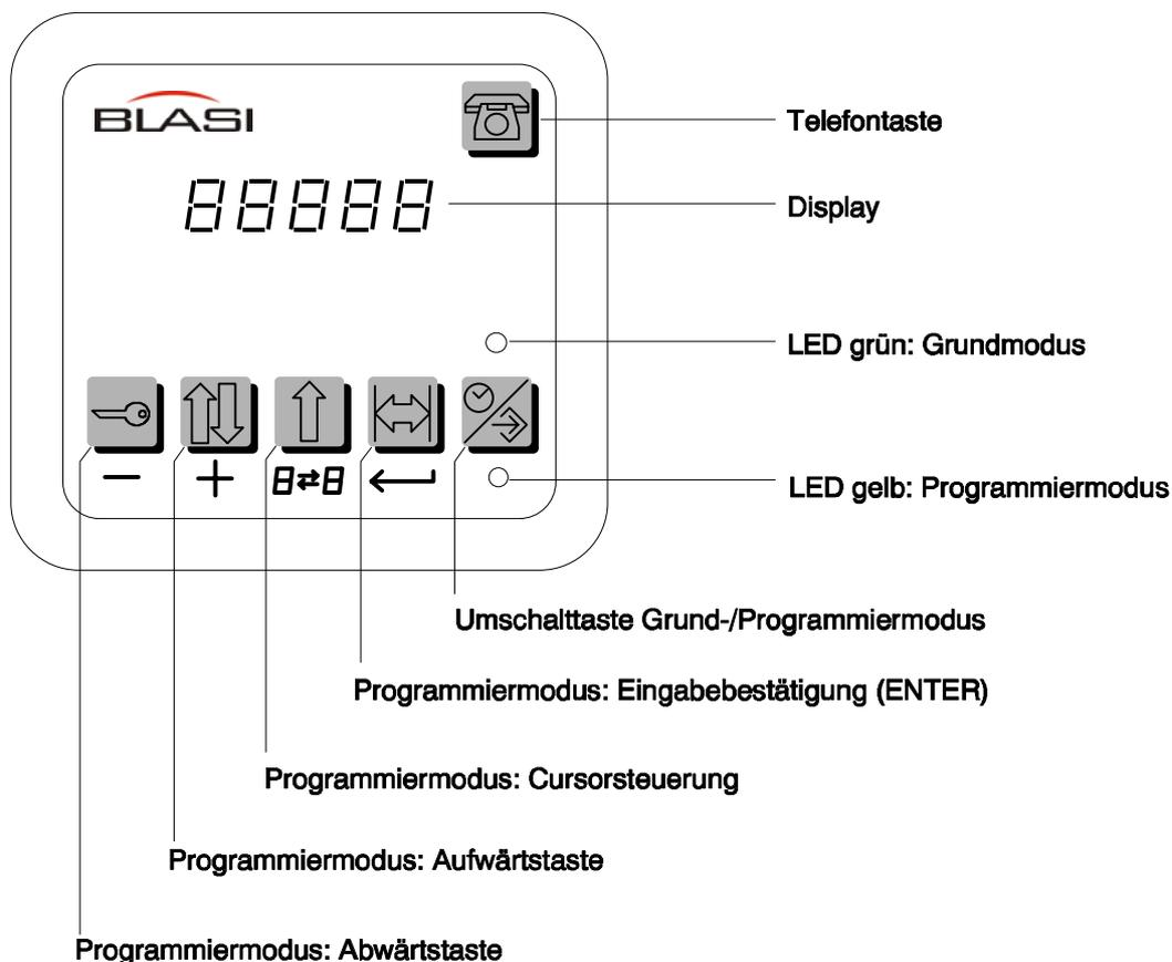
Der Intelligente Bedienungsschalter unterscheidet zwischen Grund- und Programmiermodus. Die Umschaltung erfolgt mit der Umschalttaste, wobei der aktuelle Modus durch eine grüne bzw. gelbe Dreiecks-LED angezeigt wird.
