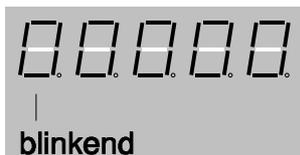
Durch Anzeige und Aufleuchten aller fünf Dezimalpunkte können durch Drücken der Enter-Taste die jeweiligen Menüpunkte eingegeben werden.
